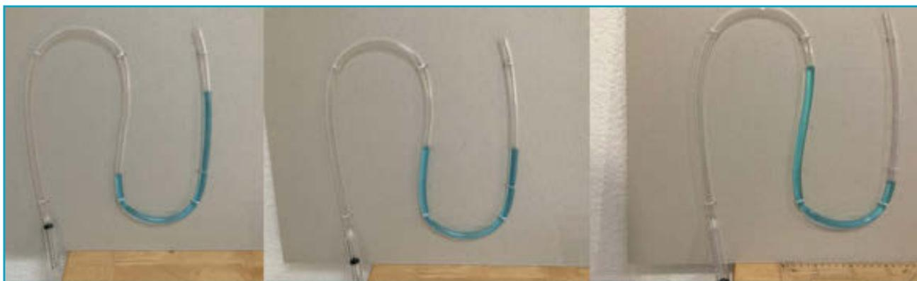
Figura 3. Manómetro casero (sobre un cartón, una manguera transparente, agua con colorante y una jeringa) con diferentes presiones manométricas. Hecho por alumnos del laboratorio de Termodinámica.
